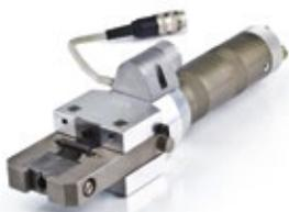
Das hydraulische Aufweitwerkzeug dient dem Aufweiten von Aluminiumrohren zur Herstellung einer LOKRING SINGLE RING-Rohrverbindung. Es ist über zwei 2,8 m lange Hydraulik-Schläuche mit dem LOKRING-Hydraulik-Aggregat verbunden. Die Vor- und Rückwärtsbewegung des Aufweitdornes wird mit Hilfe eines doppelt wirkenden Zylinders ausgeführt. Die Spannbacken und der Aufweitdorn werden dem jeweiligen Rohraußendurchmesser angepasst.
