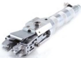
Das hydraulische Montagewerkzeug ermöglicht die LOKRING-Verbindung von Rohren mit gleichen oder unterschiedlichen Rohrdurchmessern. Die Herstellung der Rohrverbindung erfordert keine besondere Rohrvorbereitung und auch keine Fachkräfte. Das Werkzeug ist über einen 2,8 m langen Hydraulikschlauch mit dem LOKRING Hydraulikaggregat verbunden. Die Größe der Klemm- und Montagebacken ist von den Abmessungen der zu verbindenden Rohre abhängig.
