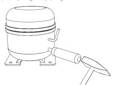
LOKRING Verbindung gemäß der LOKRING Montageanleitung für Montagetyp 00 auf www.vulkan.com durchführen.
