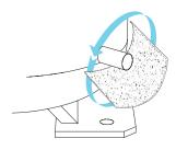
B LOKPREP 65G (03) bis zur Schnittkante des Kompressorstutzens (X¹) auf den gesamten Rohrumfang auftragen. Aushärtezeit des LOKPREP 65G (03) beachten.
