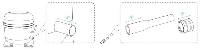
Kompressorstutzen (X¹) durch Drehbewegungen mit Schleifleinen (02) reinigen, um Lackrückstände und andere Verunreinigungen zu beseitigen.
