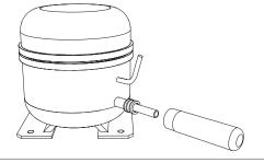
Mit einem Hammer (07) auf das NAV Montagewerkzeug (06) schlagen bis der LOKRING der NAV Verbindung (04) am Kompressorgehäuse (01) anliegt.
