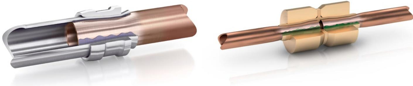
**IL LOKPREP**, sigillante anaerobico, viene distribuito tra le tubazioni prima che la connessione venga realizzata. In assenza di aria, il LOKPREP polimerizza rimanendo elastico e garantendo la tenuta nei confronti delle microperdite causate dalla non regolarità delle superfici delle tubazioni.
