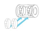
STEP 02 | PUSH THE LOKCLIP ONTO THE TUBE
