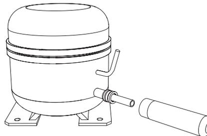
**5** Bata a conexão LOKRING NAV (04) até atingir a extremidade da ponta do compressor.
