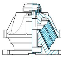
Los soportes cónicos de la serie T desarrollados para las suspensiones de motores de propulsión y grupos generadores combinan excelentes propiedades de aislamiento de vibraciones con una alta estabilidad y un limitador de desplazamiento integrado. Precargado disponible en 13 tamaños diferentes y 3 Tipos para adaptarse a la aplicación.
