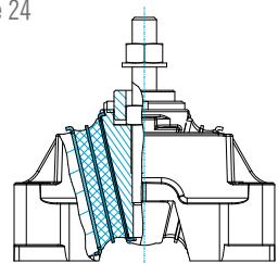
Los soportes tipo sándwich de la serie V desarrollados para aplicaciones de cajas de engranajes de motor acopladas directamente combinan excelentes propiedades de aislamiento de vibraciones con una transmisión del empuje de la hélice. La específica relación de rigidez permite altas cargas axiales con pequeños desplazamientos. La serie V está disponible en 2 tamaños, equipados con un limitador de desplazamiento integrado y versión ajustable en altura.
