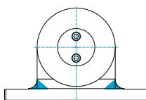
La serie AVR desarrollada para las suspensiones de caja de engranajes como soportes estables permite un alto empuje de la hélice y una transmisión del par en los soportes con pequeños desplazamientos.
