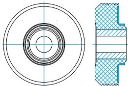
Serie CV desarrollada para suspensiones estables de caja de engranajes y motores en forma de discos sándwich precomprimidos. El aislamiento de vibraciones es óptimo también para la excitación dominante de la frecuencia de disparo de la suspensión del motor y la caja de engranajes. Disponible en varias rigideces con soportes diseñados para la aplicación.
