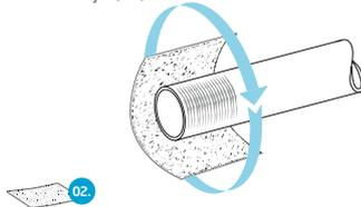
**!** Determine el diámetro externo del tubo  $\varnothing$  con la codificación del tubo o con un calibre.
