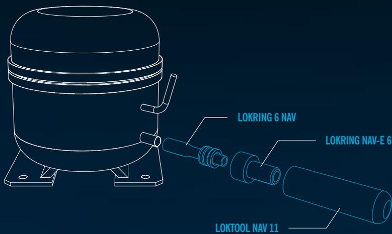
Las conexiones NAV permiten el uso de LOKRING en los extremos del tubo corto de un compresor.
