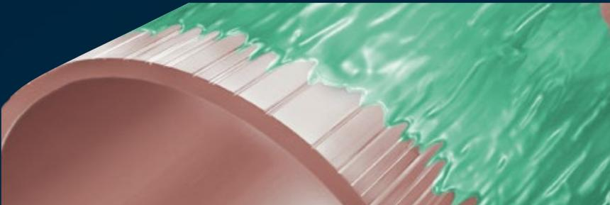
Los tubos metálicos pueden tener muescas longitudinales en la superficie de la producción. Estos defectos de producción se pueden arreglar fácilmente al humedecer los extremos del tubo que se va a conectar con líquido LOKPREP antes del montaje. Gracias a su característica capilar, puede incluso llegar a cavidades microscópicas y llenarlas por completo. LOKPREP no es un adhesivo, sino un sellador anaeróbico que solidifica al no tener oxígeno y al entrar en contacto con iones metálicos libres.
