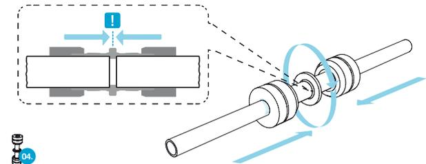
**3** Sitúe las mordazas de montaje de la herramienta de montaje manual (05) en su lugar detrás de los anillos del conector LOKRING (04). Junte la unión del tubo. **!** No cambie la profundidad de inserción de los tubos y el conector LOKRING (04). Presione la conexión del tubo hasta que los anillos del conector LOKRING (04) lleguen al tope de montaje del conector LOKRING (04). Respete el tiempo de secado de LOKPREP (03) antes de aplicar fuerza sobre la conexión.
