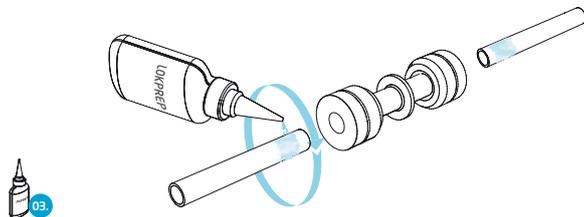
**2** Inserte ambos extremos del tubo en el conector LOKRING (04) hasta que el tubo alcance el tope interior **!**. Gire el conector LOKRING (04) 360° para distribuir LOKPREP uniformemente.
