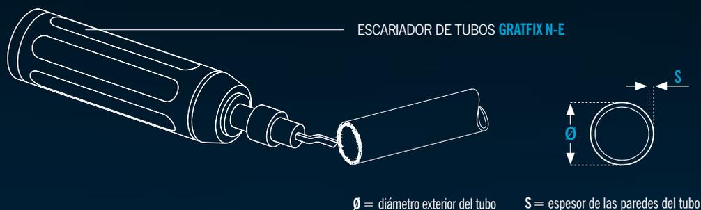
Determine el espesor de las paredes de los tubos S y el diámetro exterior Ø con la codificación del tubo o con un calibre en un tubo bien escariado.
