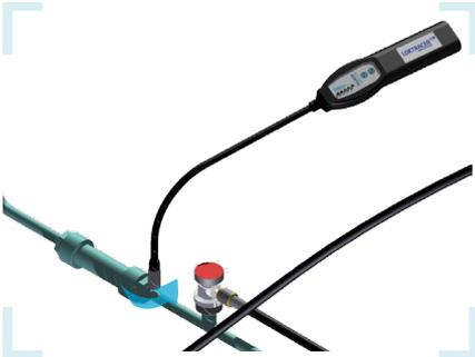
Les raccords vissés ou autres les points de connexion doivent être « palpés » lentement, c'est-à-dire que la tête de sonde (3) doit être déplacée tout autour du point de connexion.
