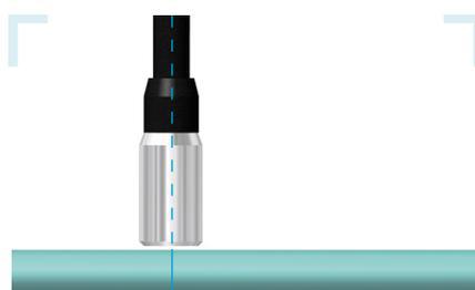
La tête du capteur doit être centrée par rapport à la surface qui doit être vérifiée.
