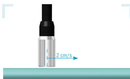
Déplacez la tête de détection lentement le long du tuyau de climatisation (max. 2 cm par seconde)
