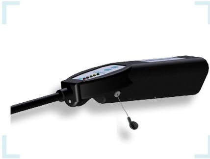
Il peut arriver que les niveaux de bruit autour de l'installation à contrôler rendent difficile la perception du signal acoustique du détecteur de fuites LOKTRACER TLD.500. Utilisez dans ce cas l'écouteur (14) et connectez le à l'entrée écouteur (13).
