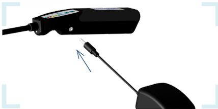
Connecter l'adaptateur secteur (15) au niveau de l'entrée des écouteurs. Si les batteries sont complètement déchargées, le temps de charge peut prendre jusqu'à 12 heures.
